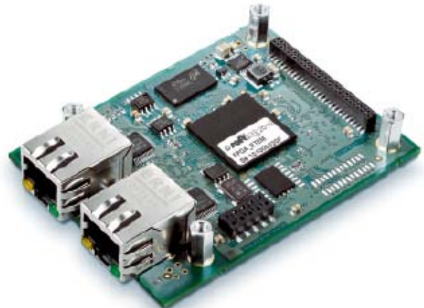
Das Embedded-Kommunikationsmodul für Industrial Ethernet stellt die erforderliche Hardware und Software für eine Feldgeräteimplementierung auf FPGA-Basis bereit.
