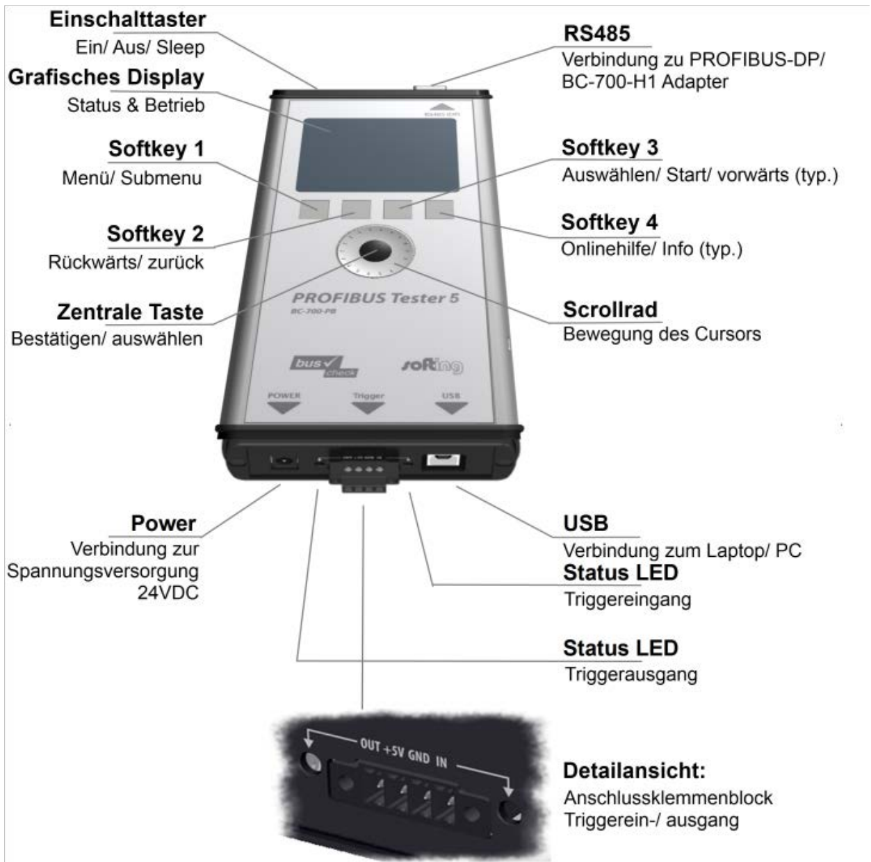
Abbildung 10: Anschlüsse, Bedienelemente und Statusanzeige des BC-700-PB
