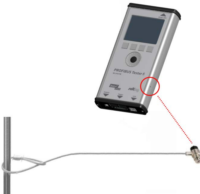
Abbildung 15: Benutzung eines Kensington-Schlusses
