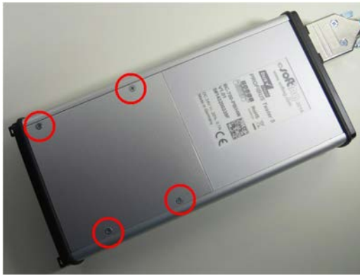
Abbildung 31: Entfernen des Deckels auf der Rückseite des BC-700-PB
