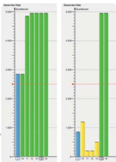
Bild 2: Beispiel für die Messung des Qualitätswerts von beiden Enden des Profibus-Segments
