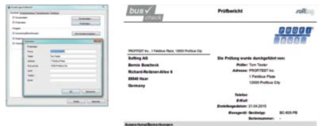
Bild 3: Ausführlicher Prüf- bericht mit einer Zusammen- fassung der Ergebnisse der Profibus-Netzabnahme
