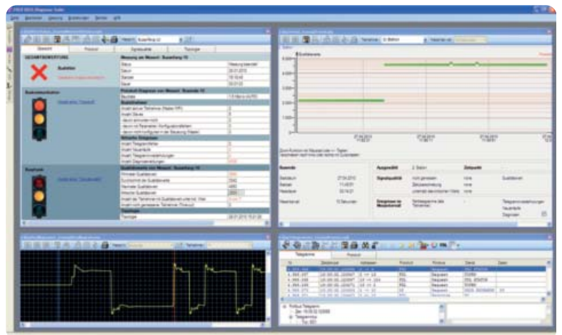
Bild 3: Ergebnisse der logischen Analyse eines (fehlerhaften) Profibus-Netzes
