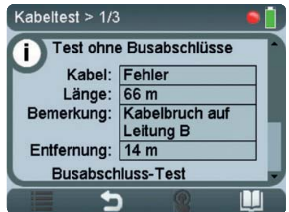
Bild 3: Ergebnisse des Profibus-Kabeltests
