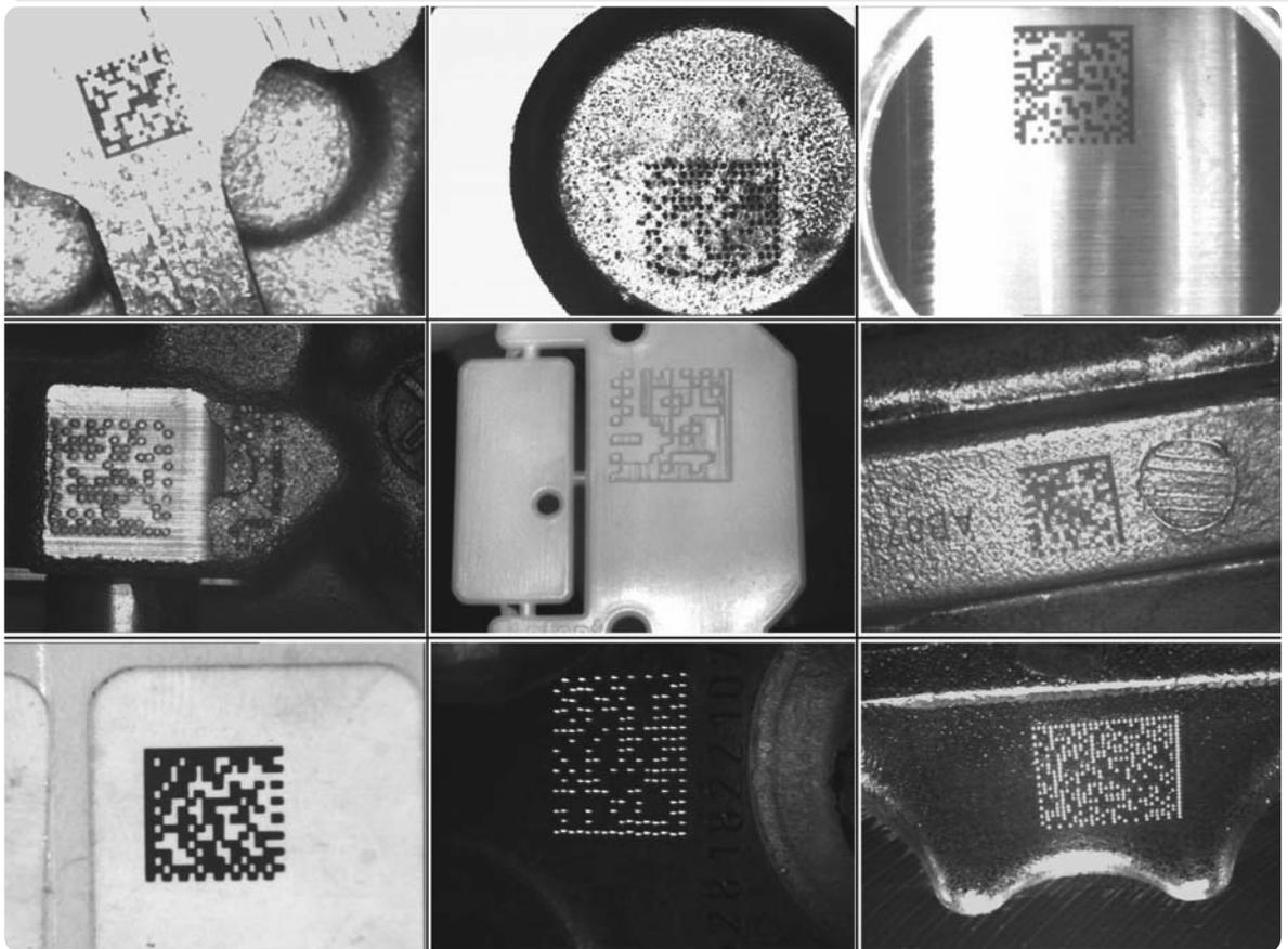
Bild 1: Qualitätsunterschiede der Markierungen auf den gekennzeichneten Bauteilen und Störgrößen der Umgebung stellen hohe Anforderungen an die Erkennungsleistung des DataMatrix-Code-Lesesystems.
